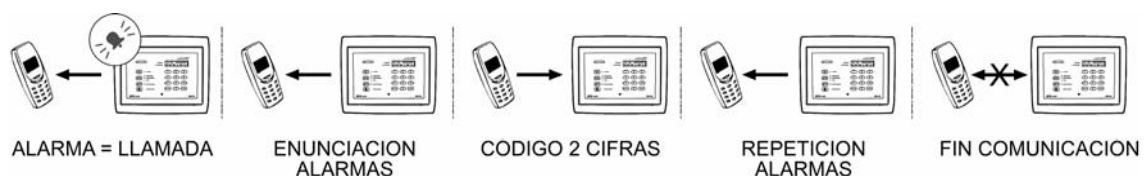
Figura 10 – Proceso de transmisión de alarmas
